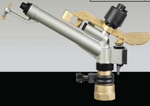
Irrigatore di media portata a funzionamento circolare o a settori. È dotato di ugelli intercambiabili e di un rompigetto a penetrazione regolabile, che assicura una precipitazione fine e uniformemente distribuita. Tra le sue caratteristiche spiccano in particolare la grande semplicità dei meccanismi e la straordinaria versatilità d'impiego. È adatto per qualsiasi tipo di impianto e si presta per terreni di qualsiasi natura ed estensione.
