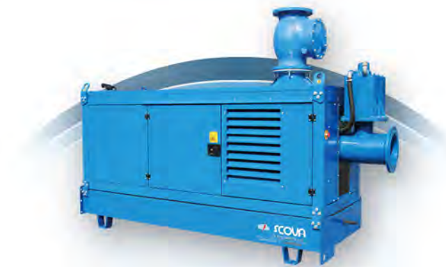
Motopompa autoadescante vuotoassistita IVECO NEF - VIESSE ITALIA, allestimento su base fissa, insonorizzazione totale con golfari di sollevamento.
